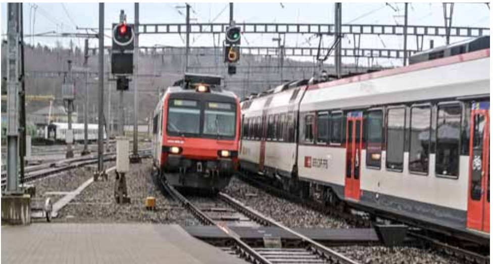
Das neuste Signalsystem des Typs N gibt numerische Angaben zur erlaubten Geschwindigkeit
