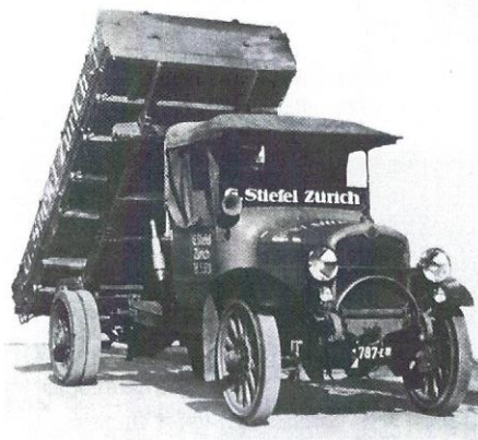
Einer der ersten Rückwärts-Kipper, bereits mit Teleskop- Presse, auf FBW, 1922 (ganz rechts: Ernst Wirz)
