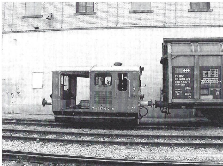
Tm 237 910-5 ist ein erst 1997 von den SBB erworbener Tm (Schienentraktor). "Tm" ist Schweizer Bezeichnung ("T" bedeutet "Traktor", d.h. Schienentraktor, "m" mit Verbrennungsmotor (Benzin oder Diesel)). Aufnahme Karl Schneider 12.5.2003
