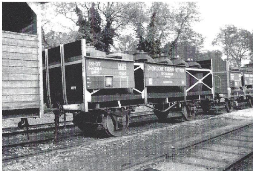
Topfwagen SBB P 546 206 am 22.10.1967 im Areal der CU. Aufnahme Kurt Niederer Baujahr 1905; 12 Töpfe für Salzsäure; Fassungsraum insgesamt 11640 l.
