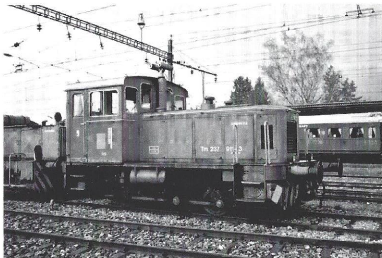
Die im Mai 1960 [1] neu in Uetikon in Betrieb genommene 240-PS-Diesellokomotive Nr. 9 am 18.01.2003 in Balsthal. Aufnahme Kurt Niederer Diese Lokomotive stammt ebenfalls von der Klöckner-Humbolt-Deutz AG in Köln. Typ A12L714R, Fabriknummer 57069. Im Jahre 1990 wurde die Lokomotive nach Full versetzt. Ihr weiteres Schicksal kennt gewiss Hansruedi Knopf; jedenfalls stand sie im Januar in Balsthal.
