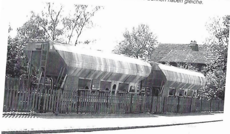
Fünf Fahr-Container der CU auf einem SBB-eigenen Flachwagen im Bahnhof Uetikon. Dieser Wagen ist von internationaler Bauart, d.h. ausländische Bahnen haben gleiche.
